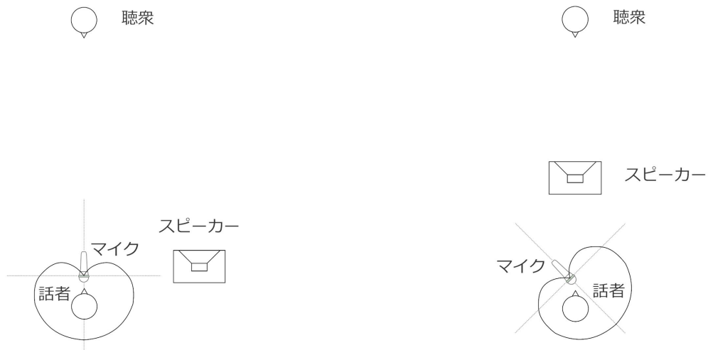
現実のスピーカー配置の一例 指向性マイクが一番感度の 低い方向にスピーカーを設置 出来ない場合が多い
